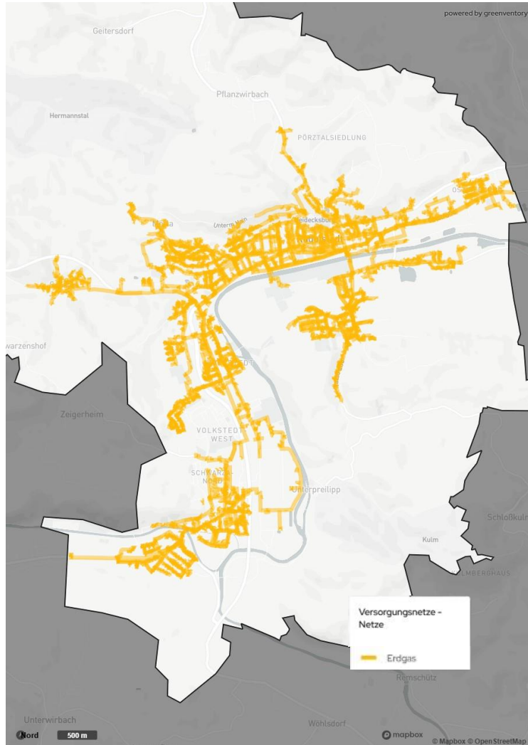
Abbildung 3-10: Gasnetzinfrastruktur im städtischen Projektgebiet
